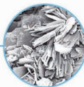
Рис. 1b: Изображение покрытия BONIT, полученное методом сканирующей электронной микроскопии (СЭМ), 2000-кратное увеличение
