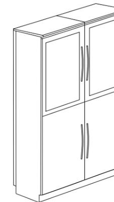
Шкаф с 2-мя металлическими дверцами внизу и 2-мя стеклянными дверцами сверху
