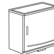
Настенный шкаф с металлической дверцей и бактерицидной лампой внутри (ширина 50 см/80 см/100 см)
